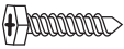
E. #8 Self-drilling sheet metal screw Tornillo para plancha de metal autopercorante n.º 8 Vis à métal autotaraudeuse no 8
