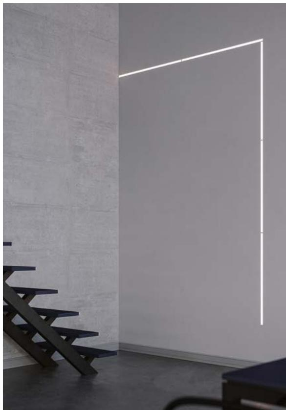
A Gravity dispõe de uma multiplicidade de peças capazes de dar uma solução para cada requisito da instalação através da calha magnética de 1, 2 ou 3 m, seja à superfície ou encastrado. Além disso, o sistema permite criar facilmente a configuração pretendida: horizontal ou vertical, no teto e/ou na parede. O sistema também se pode instalar de forma suspensa, utilizando varetas/cabos de suspensão e tampas decorativas.
