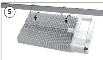
Hold the module firmly with two hands and position both hooks of brackets (A) over both hooks of bracket (B). / Tenez la module fermement par les deux mains et positionnez les deux crochets de l'étrier (A) sur les deux crochets de l'étrier (B).
