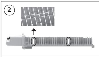
The module has two standard included brackets (A), to install by means of both mounting features in Fig.2 and 3a. Push the bracket end firmly inside the mounting feature with the palms of your hands, as show with both arrows in Fig.3a. / Le module est livré avec un étrier a ressort standard (A), a monter via les deux caractéristiques de montage sur l'image 2 et 3a. Pressez fermement sur l'extrémité du étrier avec la paume du vos mains vers la caractéristique de montage illustrée à l'image 3a.
