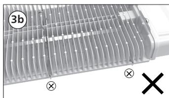
Do not use the hook to push, use only the bracket end to push the brackets. Make sure the bracket (A) is firmly clamped inside the mounting feature. The bracket end must not be protruding as shown in Fig.3b. / Ne pas utilisez le crochet pour pousser, utilisez uniquement l'extrémité des étriers pour pousser des étriers. Assurez-vous que l'étrier est fermement fixé sous la caractéristique de montage. L'extrémité des étriers ne doit pas dépasser comme indiqué à l'image 3b.
