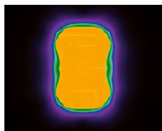
LO: Verlichting van een sportveld met schijnwerpers met beperking van strooilicht (LO)
