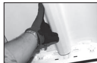
Figure 6. Le réflecteur se glisse dans les lances
