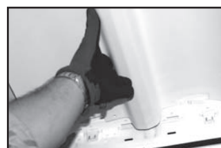
Figure 6. Le réflecteur se glisse dans les lances
