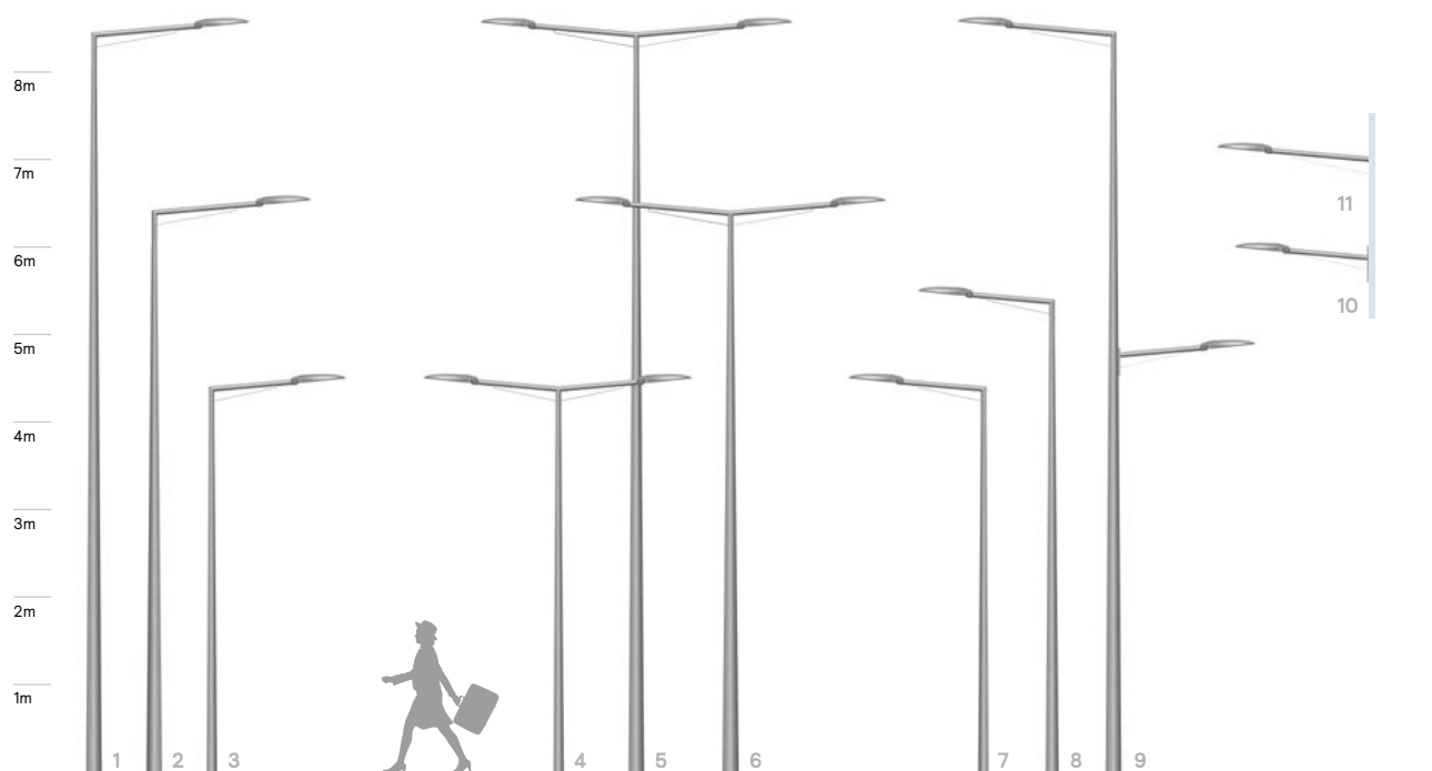
1-2-5-6. Modena LED gen2 + crosse Féroé L1200 + Mât Accante 3-4-7-8. Modena LED gen2 + crosse Féroé L1000 + Mât Accante 9. Modena LED gen2 + crosse Féroé L1200 + Mât Accante + contre-feu Féroé L1000 10. Modena LED gen2 + applique murale Féroé L1000 11. Modena LED gen2 + applique murale Féroé L1200
